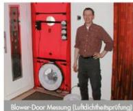
Blower-Door Messung (Luftdichtheitsprüfung)
