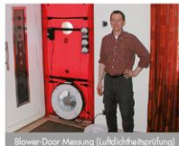
Blower-Door Messung (Luftdichtheitsprüfung)
